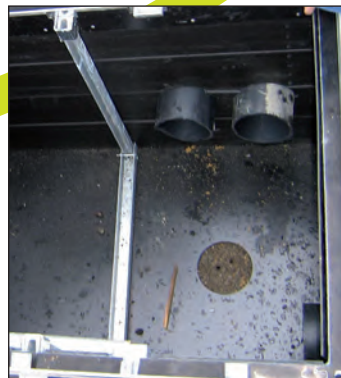
vertikal leicht teilbar, Profil mit Eckverbindungselement, Entwässerungsöffnung in der Bodenplatte
